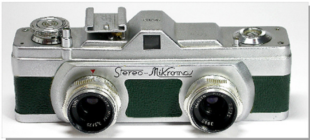
Drei Beispiele aus der Abteilung Stereofotografie: Ganz oben eine gut erhaltene Stereo-Rollefilmkamera namens Rolleidoscop von Franke & Heidecke (Rollei), darunter die Stereo-Mikroma von Meopta für Kleinstbildfilm 16 mm. Das Bild rechts zeigt ein absolutes Highlight der Sammlung: den Stereo-Diabetrachter Planox-Heidoplast von Franke & Heidecke (Rollei) aus den 20er Jahren des vorigen Jahrhunderts.
